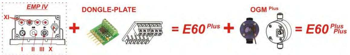
Ist ein OGM<sup>Plus</sup> angeschlossen, so wird mit Aktivierung der Dosierregler-Funktion die durch den OGM gemessene Dosiermenge mit einem eingestellten Dosiermengen-Sollwert verglichen. Ergibt sich hierbei eine Abweichung wird die Dosierfrequenz der Pumpe automatisch erhöht bzw. vermindert.
