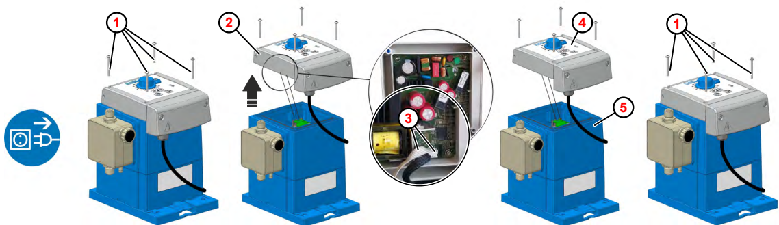
Fig. 18: Sostituire la centralina di comando
