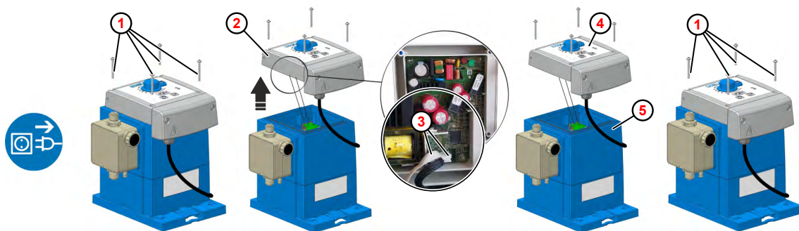
Fig. 18: Remplacement de l'unité de commande
