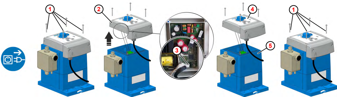
Fig. 18: Sustituir la unidad de control
