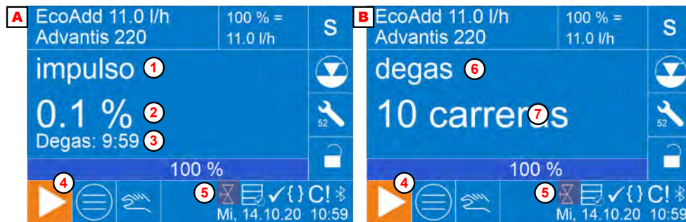
Fig. 6: Proceso de purga, de desgasificación
