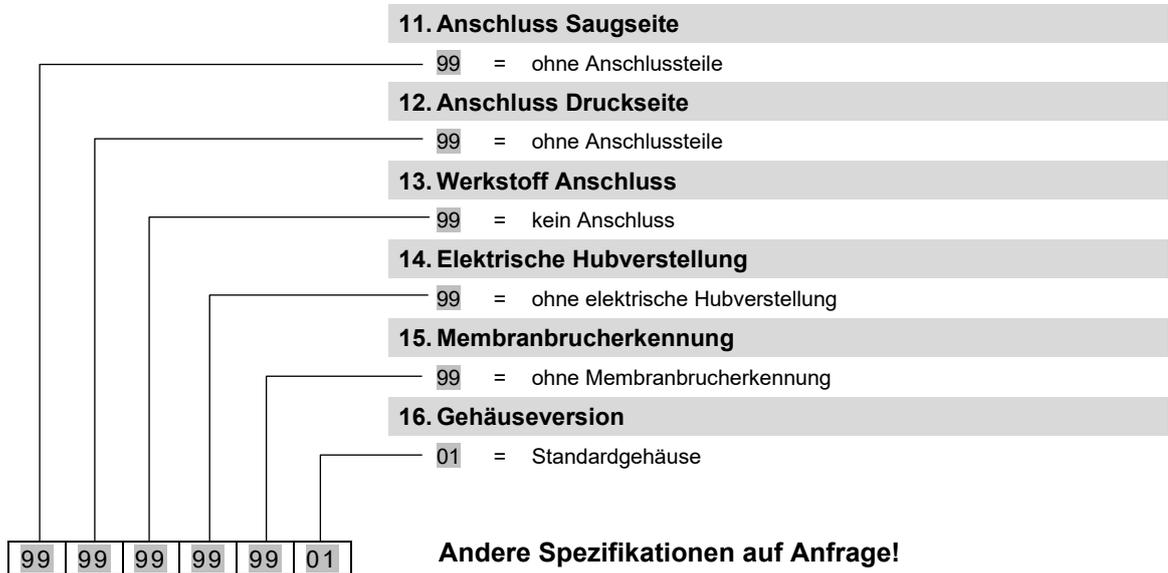
Beispiel für den kompletten Pumpenschlüssel einer Standardpumpe:
