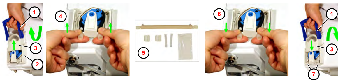
Fig. 21: Sostituzione tubo schiacciato
