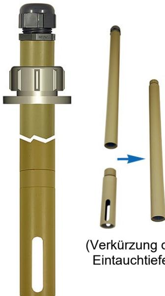
**Eintaucharmatur für pH/Redox-Einstabmessketten**
