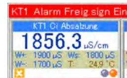
Für die Einstellungen für Absalzüberwachung und Signalüberwachung siehe Betriebsanleitung 417102269, Kapitel „Versatronic Kühlwasser“.
