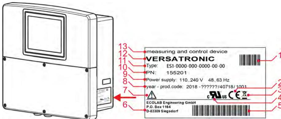
Abb. 1: Typenschild auf Gerätegehäuse
