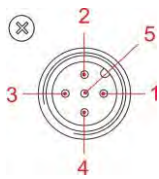
Abb. 8.6 Anschlussbelegung Steckplatz VII (5-polig), Eingang für Chargenimpuls und Dosiersperre
