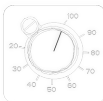
Fig. 9.2 Réglage de la capacité de dosage (mécanique)
