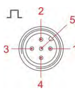
Abb. 8.9 Anschlussbelegung Steckplatz VIII (5-polig), Eingang für Impuls, Normsignaleingang
