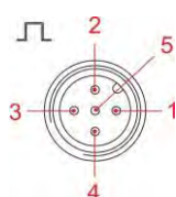
Fig. 8.9 Affectation des connexions - emplacement enfichable VIII (à 5 broches), entrée de l'impulsion de charge et du blocage du dosage
