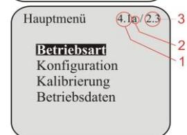
Wurde eine Dongle-Box oder ein MicroFlow<sup>PLUS</sup> angeschlossen, so wird die Version der Einheit (Pos.3) rechts neben der Pumpenversion dargestellt.
