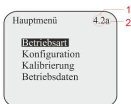
Die aktuelle Softwareversion (Pos.1) wird im Display des Hauptmenüs rechts oben (Abb. 9.6 & 9.7) angezeigt. Kleinbuchstaben hinter der Softwarenummer (Pos.2) beschreiben interne Softwareänderungen, die keinen Einfluss auf die Bedienung des Gerätes haben.
