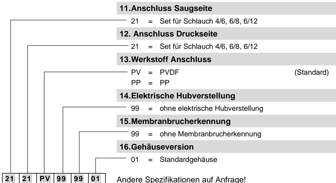
Beispiel für den kompletten Pumpenschlüssel einer Standardpumpe:
