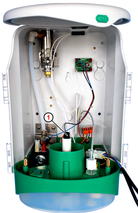
Abb. 17: Sprühdüse ausbauen
