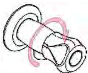
Fig. 22: Robinet : fermeture de l'arrivée d'eau
