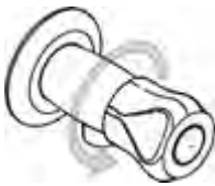
Fig. 16: Robinet : ouverture_arrivée d'eau
