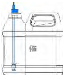
Fig. 6: Bidon avec sonde de niveau
