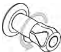
Fig. 13: Valvola: apertura dell'alimentazione dell'acqua
