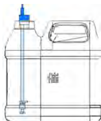
Fig. 6: Bidón con sonda de nivel de llenado
