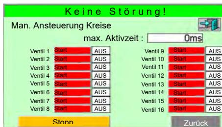
⇒ Bildschirm „“ öffnet und zeigt den aktuellen Schaltzustand der Schmierkreise (Ventile).
