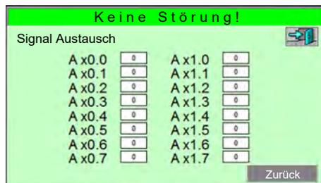
⇒ Bildschirm „Signal Austausch“ öffnet und zeigt den Zustand aller Ausgangsbytes, die über Ethernet an die Anlage übertragen werden.“
