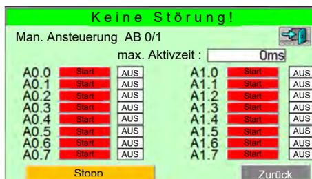
⇒ Bildschirm „Man. Ansteuerung AB 0/1“ öffnet und zeigt den Schaltzustand der digitalen Ausgänge an der entsprechenden Ausgangsschnittstelle.
