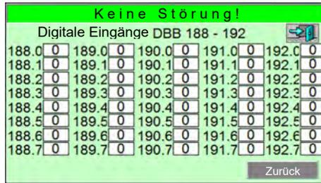
⇒ Bildschirm „Digitale Eingänge DBB 188 - 192“ und zeigt den Zustand aller Eingangsbytes, die über Ethernet an die Steuerung übertragen werden.
