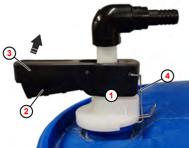
Abb. 17: Click & Plug Anschlusskupplung entriegeln
