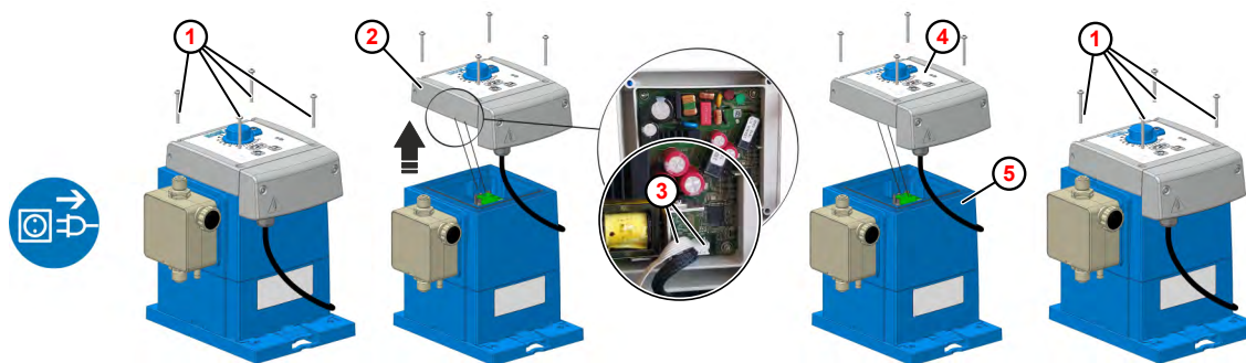
Fig. 18: Sostituire la centralina di comando
