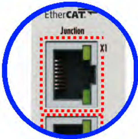
Abb. 12: Kennzeichnung FHC-Port am EK1122-0080 bzw. EK1101-0080
