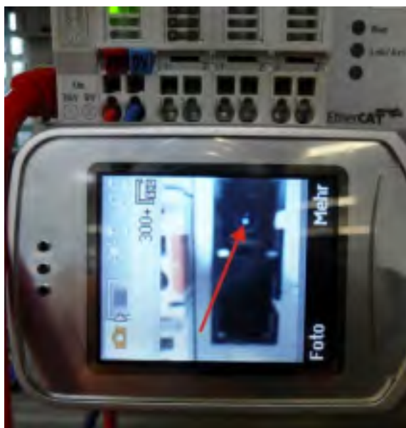
Abbildung: Visualisierung von infrarotem Licht am SC Duplex Stecker
