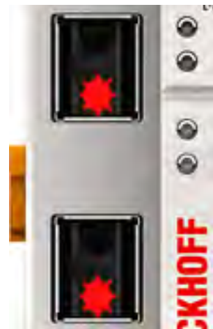
Abbildung: Transmitterkanäle beim EK1541
