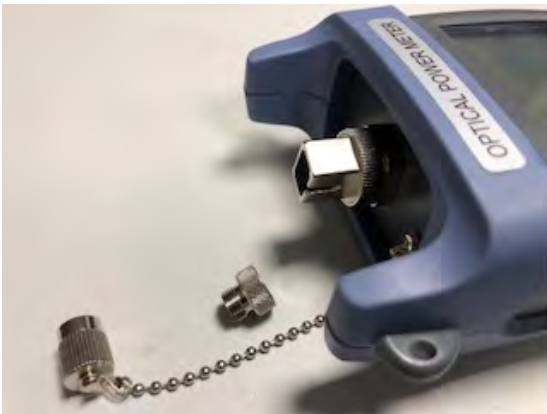
OPM mit aufgeschraubtem SC Adapter
