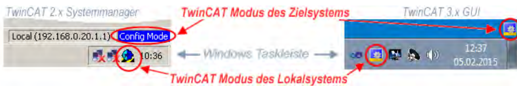
Abb. 116: Unterscheidung Lokalsystem/ Zielsystem (links: TwinCAT 2; rechts: TwinCAT 3)
