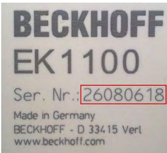
Abb. 2: EK1100 EtherCAT Koppler, Standard IP20-IO-Gerät mit Seriennummer/ Chargennummer
