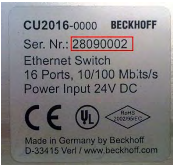
Abb. 3: CU2016 Switch mit Seriennummer/ Chargennummer
