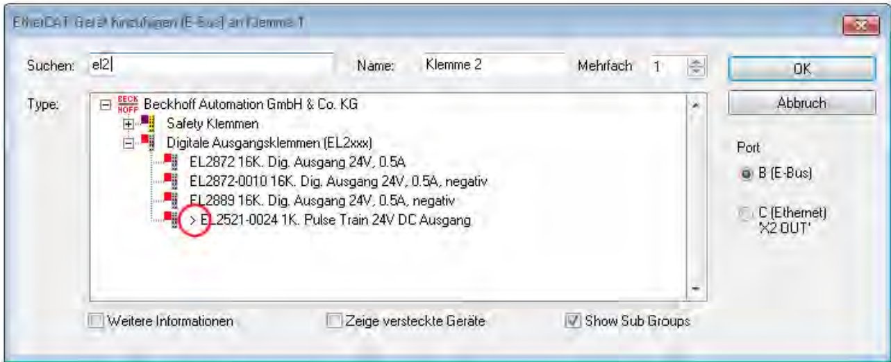
Abb. 83: Kennzeichnung einer online erfassten ESI am Beispiel EL2521
