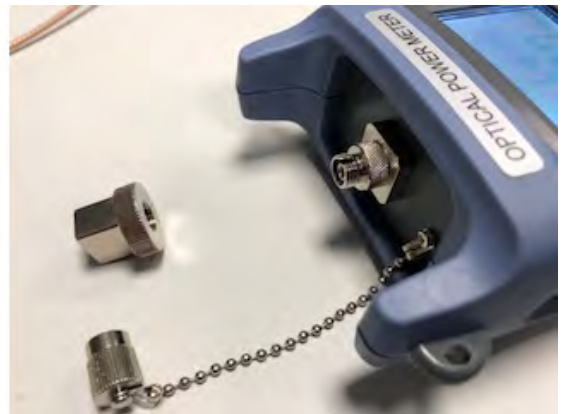
OPM mit aufgeschraubtem FC Adapter
