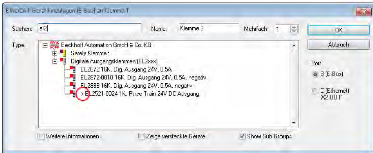
Abb. 102: Kennzeichnung einer online erfassten ESI am Beispiel EL2521
