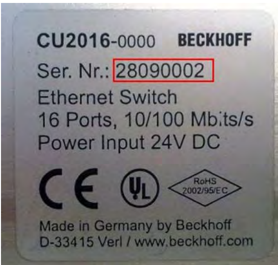
Abb. 3: CU2016 Switch mit Seriennummer/ Chargennummer
