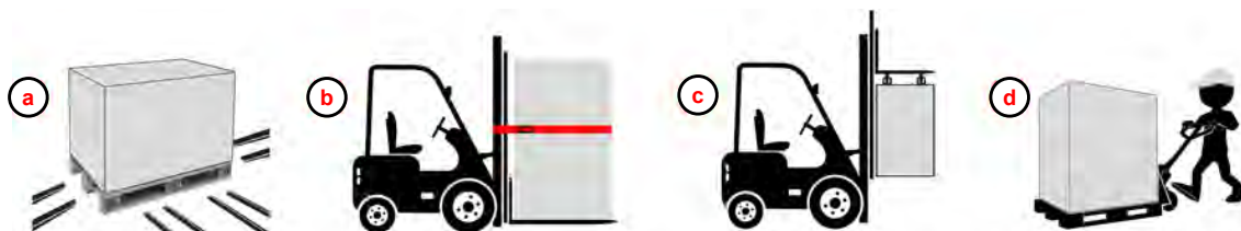
Rys. 1: Transport palet za pomocą wózka widłowego i wózka paletowego (zarys zasad)
